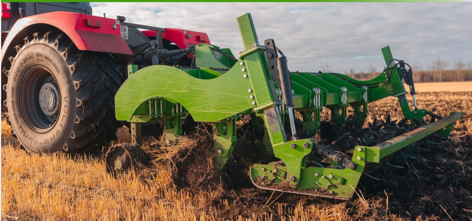
Агрегаты серии "Труженик" применяются для глубокого рыхления уплотненного непромокаемого слоя почвы с целью разуплотнения плужной подошвы без оборота пласта и без повреждения стерни. Данный вид обработки улучшает водно-воздушный режим корневого слоя почвы и предотвращает развитие её эрозии, накопление влаги и способствует повышению урожайности сельскохозяйственных культур.
