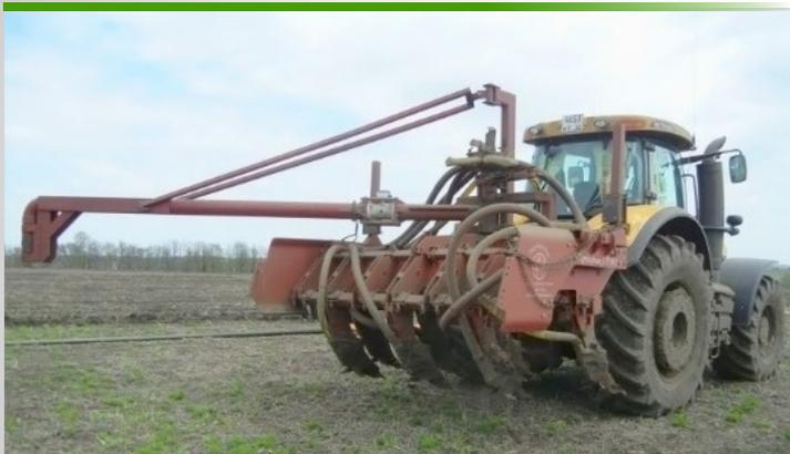
Система внесения жидкого навоза закрытым способом от лагун непосредственно в почву на базе глубокорыхлителей «Труженик». Позволяет вносить жидкий навоз на глубину до 500 мм. Количество стоек от 5 до 13 шт. Агрегируется с тракторами мощностью от 180 л/с.
