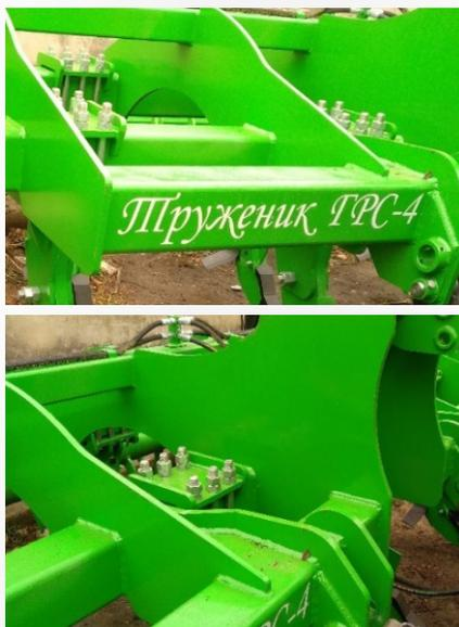
Усиленная сварная рама выполнена из материала, используемого при строительстве мостовых конструкций.
